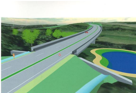
Bild 1. Parametrisierte Konstruktion eines Regenrückhaltebeckens mit ConKit.
