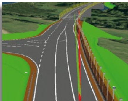
Abb. 5 - Sichtweiten und Hinderniskontrolle in der 3D-Projektansicht.
