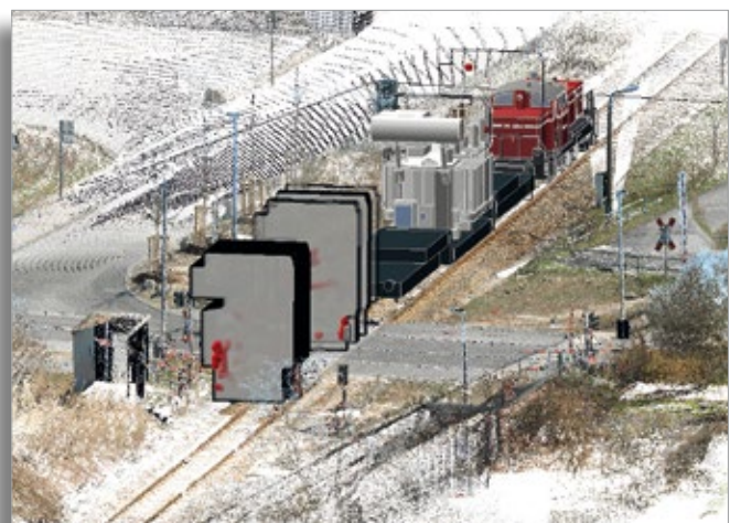
Bild 2 – Schwerlasttransport am Bahnübergang – Beispiel einer Kollisionsprüfung mit dem Add-on Punktwolke der GEOPAC-3D-Hüllkurve.
