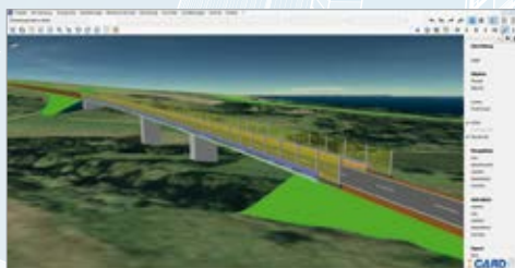
Der Brückengenerator unterstützt den BIM Planungsprozess.
